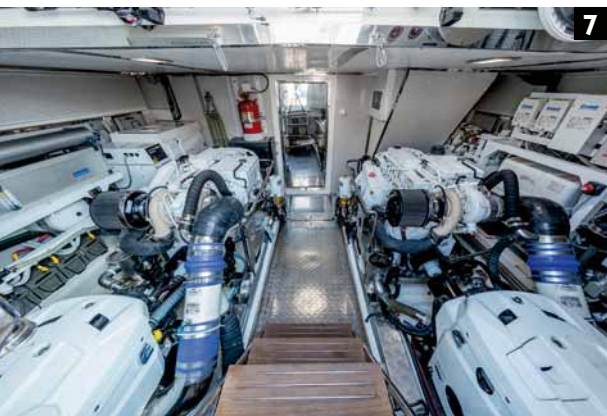
5. La scala che conduce dal salone alla zona notte, sulla destra si intravede la cabina dell'armatore. 6. Cabina Vip di prua e ospiti hanno bagni riservati. 7. La sala macchine con i due motori Cummins Qsb 6.7 da 550 cv. 8. Bella la zona tecnica di prua con verricello elettrico rialzato, in modo da evitare situazioni pericolose quando si manovra con l'ancora.
